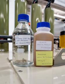
Une fois extrait des boues, l'azote est transformé en sulfate d'ammonium transparent et inodore. Il est stocké sur place, sans risque, dans un réservoir souple. L'exploitant de la step d'Yverdon Marcel Pürro (à g.) collabore avec les agriculteurs Martin Häberli et Éric Stoll (à dr.) qui ont choisi de l'épandre dans leurs champs
